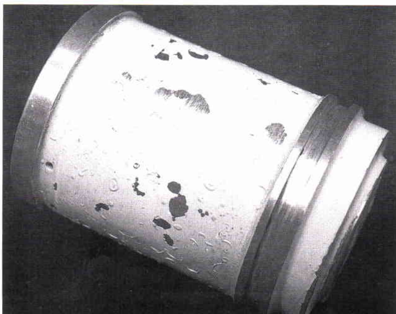
Exempel på en detalj, som kan ges ökad livslängd med fluorlack.
